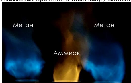
Рис. 1. Смешанный массив противоточных струе на основе метана и аммиака
