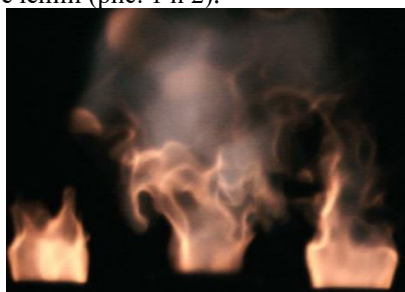
Рис. 2. Воспламенение аммиака в массиве противоточных струй
