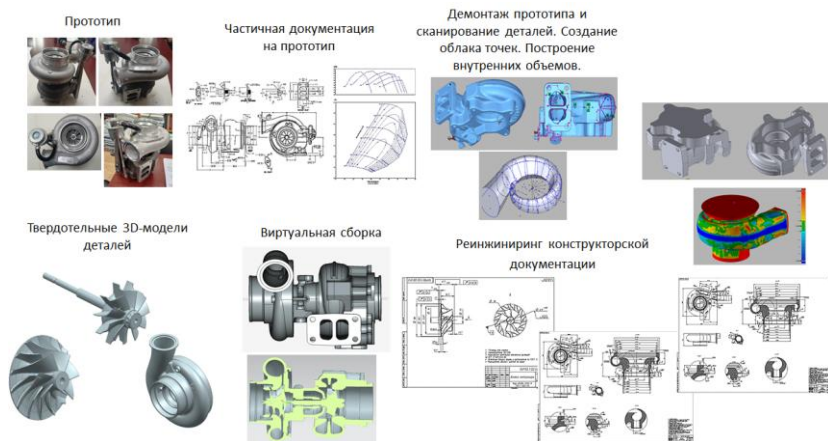
Рис. 1. Схема реализации проекта от прототипа до реинжиниринга конструкторской документации турбокомпрессора и виртуальной сборки
