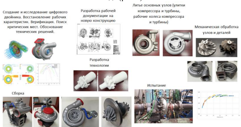
Рис. 2. Схема реализации проекта от CAD-модели турбокомпрессора до разработки технологической оснастки, изготовления, сборки и испытания турбокомпрессора
