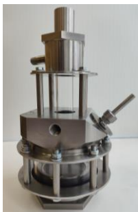
Рис.1. Противоточное вихревое горелочное устройство
