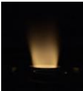
Рис. 1. Исследование горения аммиака в противоточной вихревой горелке
