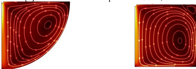
Рис. 2. Развитие ЭВТ в полусферической (слева) и цилиндрической (справа) рабочих областях
