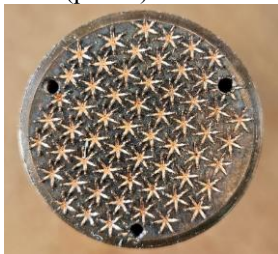
Рис. 1. Фотография образца из меди, модифицированного электронным лучом.
